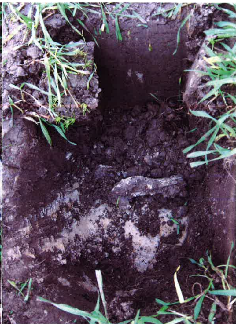
Verranelohkolla kuoppa ja ruokamultakerros pysyvät kuivana, kun pohjamaa on läpäisevää.
