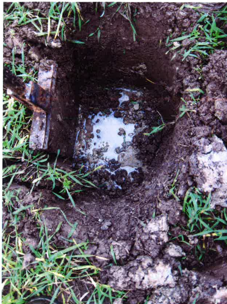
Ongelmalohkolla kuoppaan kertyy vettä, kun pohjamaa on tiivistynyttä ja ruokamultakerros on märkä.
