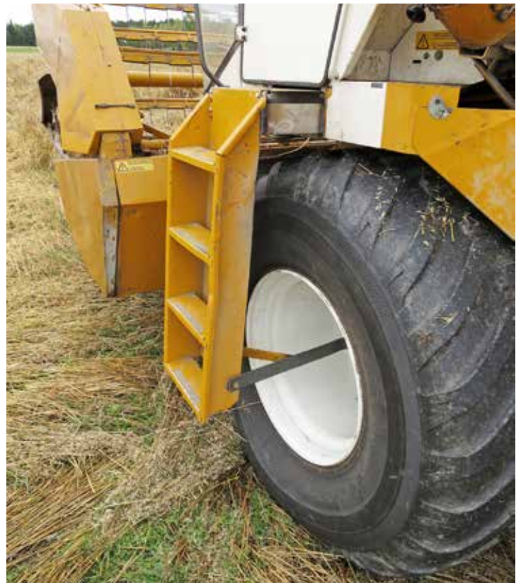
Muutostyönä portaiden yläpään lisättiin jatkopala ja alapään tuki- rauta pidennettiin.
