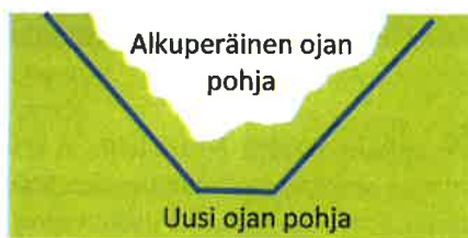
Kuva 4. Ojan syvennys tuottaa runsaasti maamassoja. Maata tulee sitä enemmän, mitä syvemmälle kaivetaan ja mitä loivemmat luiskat tarvitaan.
